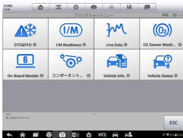
図 4-17 OBD II 診断メニューのサンプル
