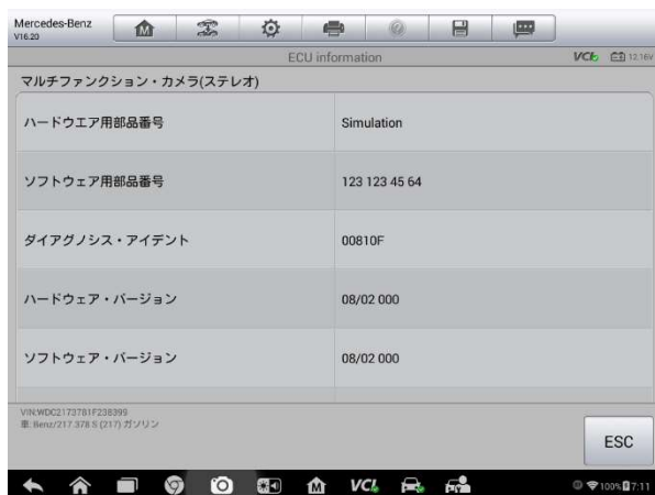
図 4-9 ECU 情報画面のサンプル
