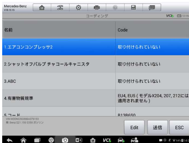
図 4-15 バリエーションコーディング画面のサンプル
