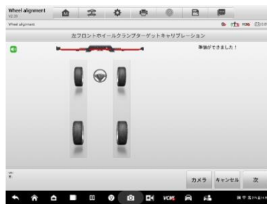
14、左フロントのタイヤを空転させます。(手でタイヤを回してください)
