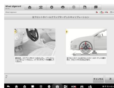
12、LF用のタイヤクランプターゲットを前輪左側に装着【次】を選択
