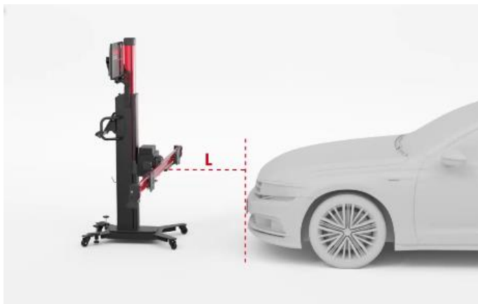
図 6-108 キャリブレーションフレームを中央に配置
