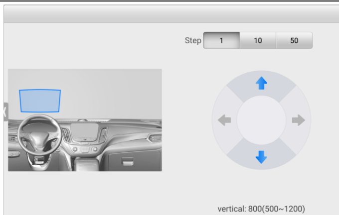
図 6-90 ヘッドアップディスプレイ画像補正
