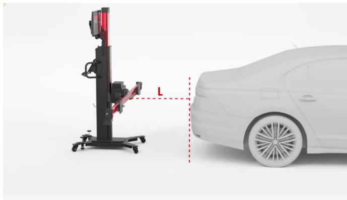
図 6-30 キャリブレーションフレームを中央に配置
