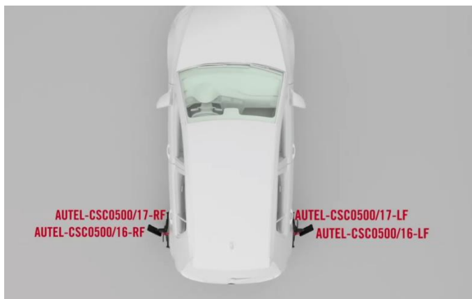
図 6-31 ホイールクランプ(タイヤクランプ)とターゲットを取り付けます
