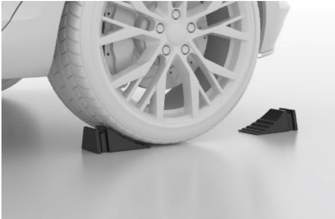
図 6-75 車輪止めの設置
