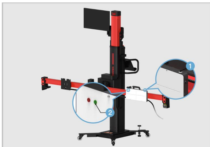
図 6-131 NV キャリブレーターの起動
