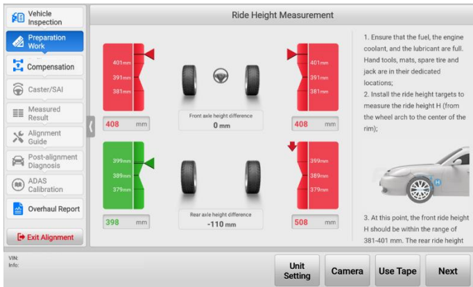
図 4-33 車高ターゲットを使用して車高を測定
