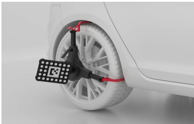
図 6-137 ホールクランプ(タイヤクランプ)とターゲットを取り付けます
