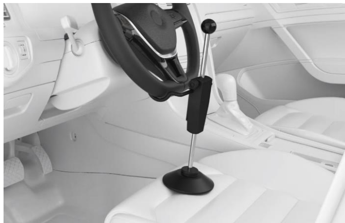
図 6-43 ステアリングロックの設置
