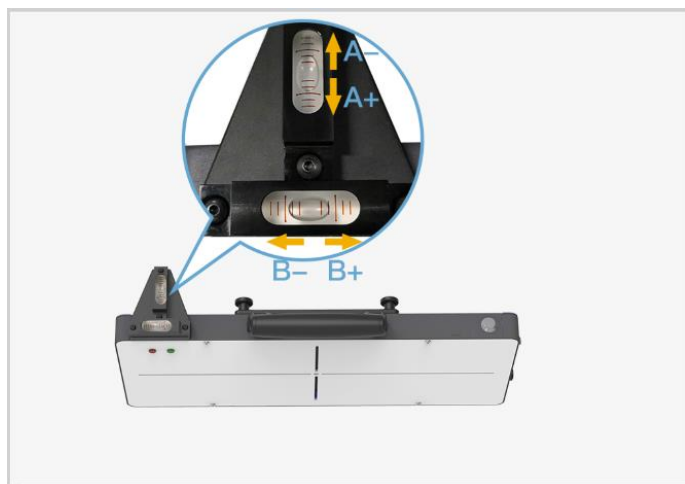
図 6-103 気泡を水平器の中央に合わせる
