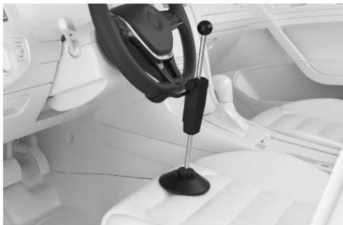
図 6-147 ステアリングロックの設置
