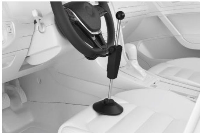
図 6-76 ステアリングロックの設置
