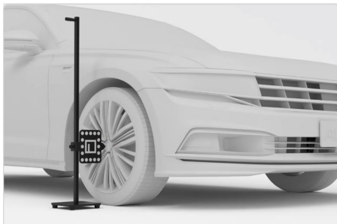
図 6-138 距離測定ターゲットの設置
