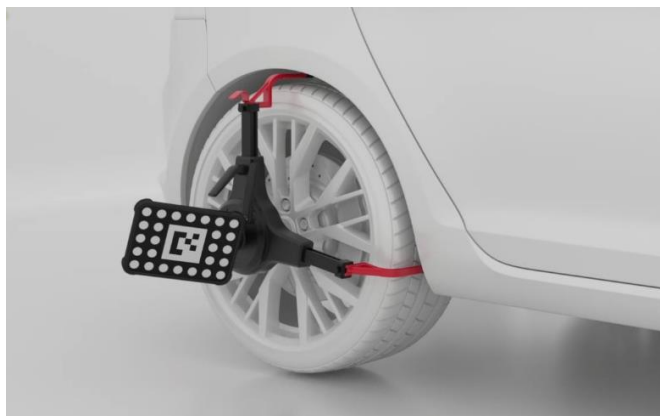
図 6-122 ホイールクランプ(タイヤクランプ)とターゲットを取り付けます
