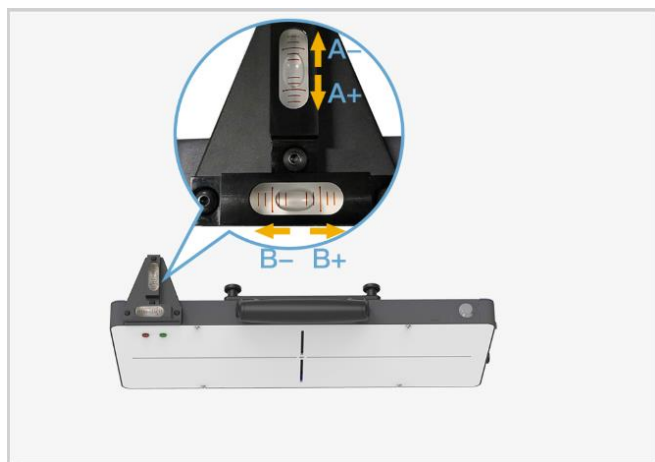
図 6-116 気泡を水平器の中央に合わせる
