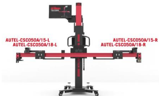
図 6-79 延長ロッドと 2 ラインレーザーの取り付け
