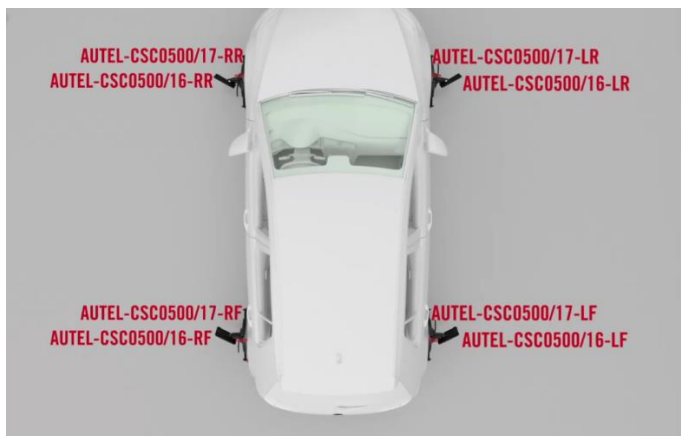
図 6-45 ホイールクランプ(タイヤクランプ)とターゲットの取り付け
