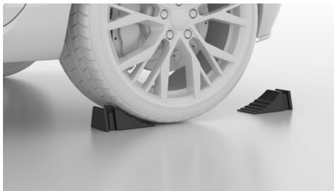
図 6-42 車輪止めの設置
