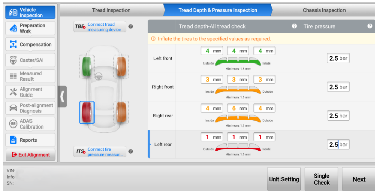
図 27 トレッド深さおよび空気圧検査画面 2
