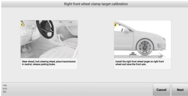
図 33 キャリブレーションの準備(車両を使用) 1
