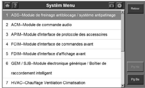
Figure 3.19: Unité de contrôle System Menu écran
